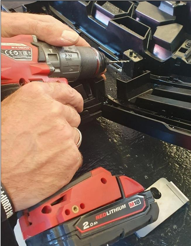
Löcher mit 2,5 mm vorbohren
