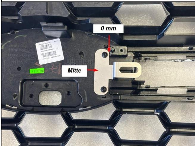
Halter B15T4831 entsprechend Bilder ansetzen und Bohrlöcher markieren. (Bauteile sind links/rechts identisch)
