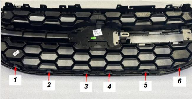
Bild zeigt die schwergängigen Clips, welche mit Silikonspray vorbehandelt werden sollten.
