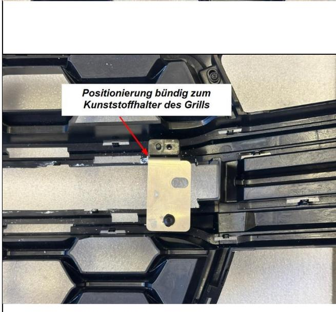
Halter B15T4830 XXXXX R und B15T4830 XXXXX L ansetzen und Bohrlöcher markieren. Hinweis: Links/Rechts-Teil unterschiedlich
